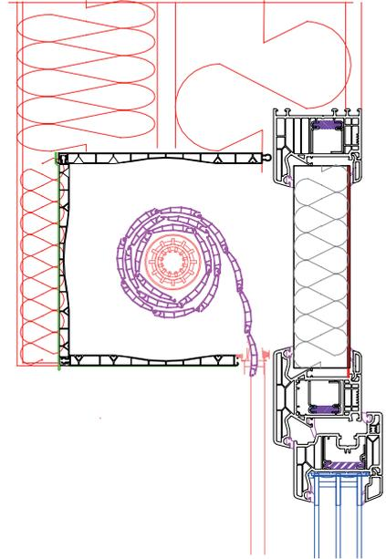
Nuestro sistema de cajón invertido es una **solución apta para proyectos de alta eficiencia energética y casa pasiva** ya que consigue eliminar el puente térmico que causa un monoblock tradicional. Además, esta ventana ha sido **certificada RC2 por el Ift Rosenheim**, garantizando la máxima seguridad en el hogar.
